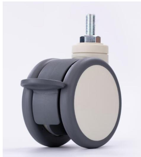
脚轮主架采用强承载能力的尼龙（PA6）材质，其优良的耐油性、耐磨性、耐药性和耐化学品性保证了脚轮的使用寿命，轮芯采用强承载能力的聚丙烯（PP）材质。
